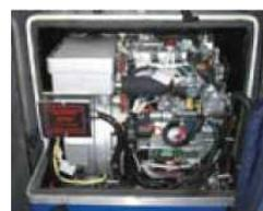
QFK капсула стандартна для генераторов до 25 кВт
